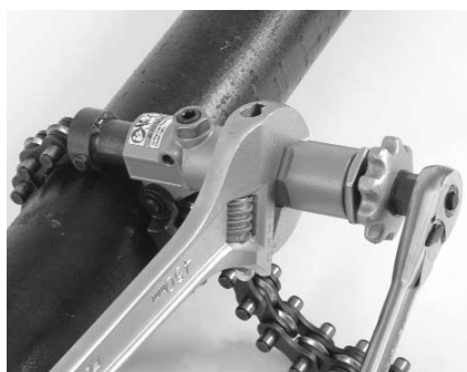
Figure 4 – Utilisation manuelle du coupe-tubes à chaîne
