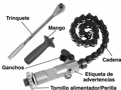
Figura 1 – Cortadora de tubos cloacales 238-P
